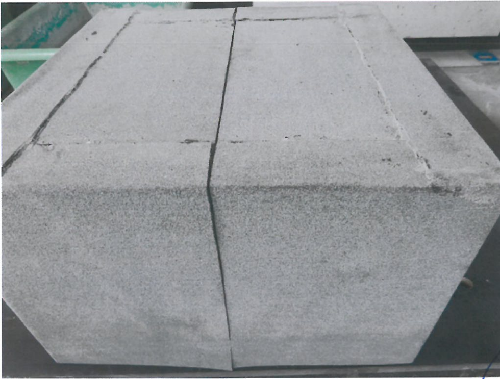
Bild 5: aneinander gestellte Bodenplattenelemente
