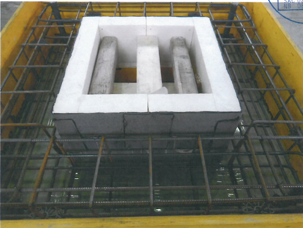
Bild 16: Prüfkörper vor der Betonage des 2. Abschnittes
