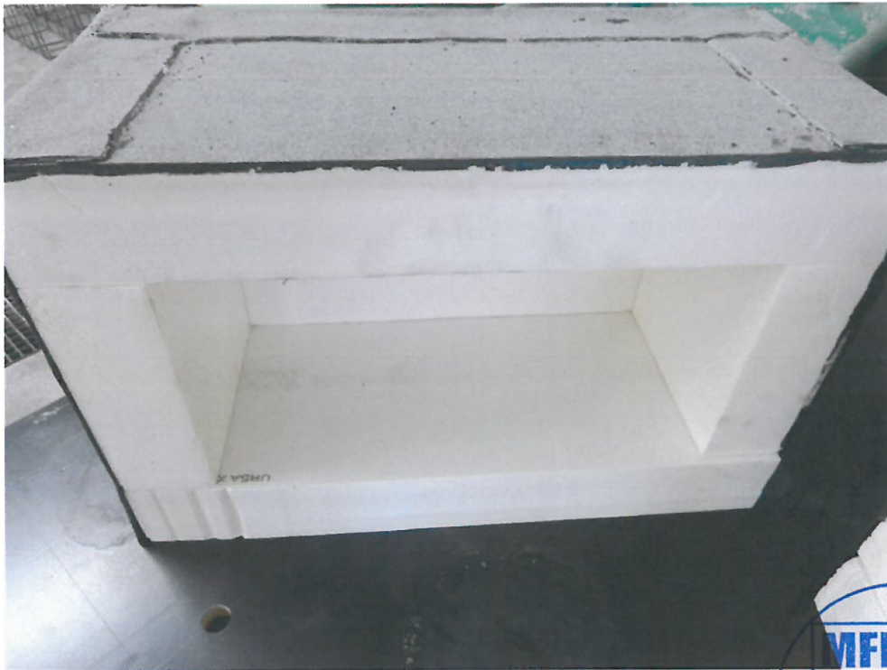
Bild 1: Schalungselement für Bodenplattenvertiefung
