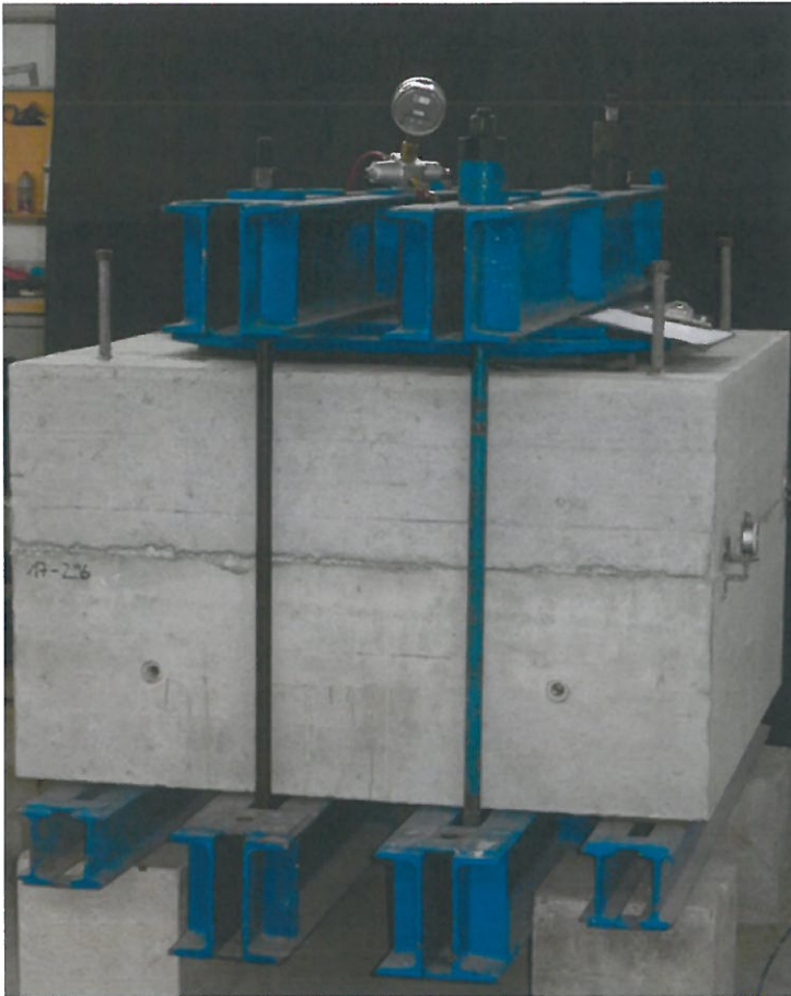
Bild 17: Prüfkörper während der Druckwasserbeanspruchung bei 5 bar
