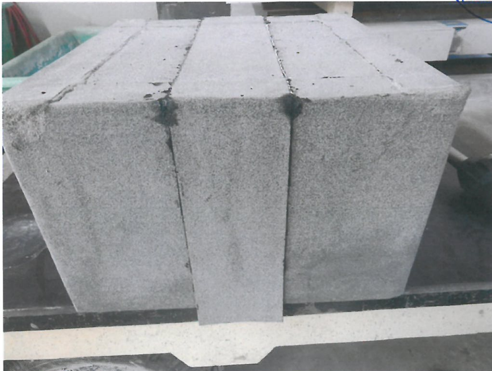
Bild 8: fertige Bodenplattenschalung mit Überlappungsstoß
